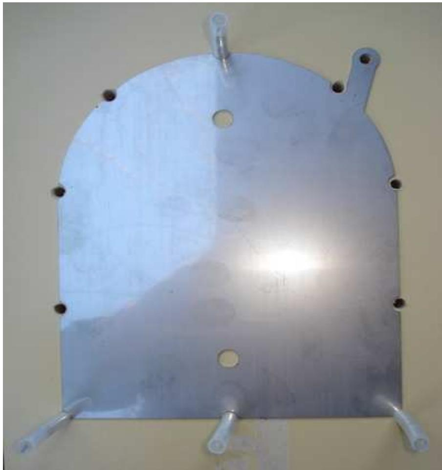
Durch die vier Bolzen wird die Platte festgehalten, die restlichen Bohrungen können vorgenommen werden.
