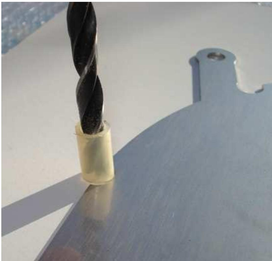
Legen sie nun eine Hülse ( 8x6 mm ) bündig an die Platte an und beginnen langsam das Loch zu bohren. Es werden alle 10 Umrandungsbohrungen und die eine Bohrung für den elektrischen Anschluss vorgenommen
